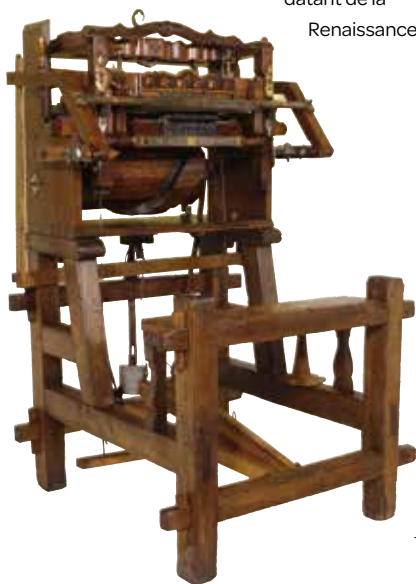
Métier rectiligne à bâti bois, mû au pied, 18 e siècle, Inv. MB227
